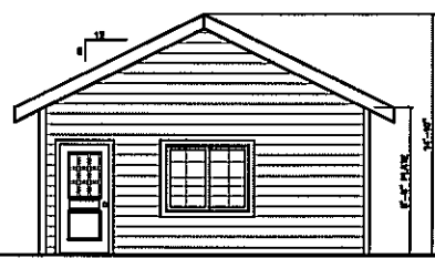
EAST ELEVATION SCALE: 1/8" = 1'-0"
